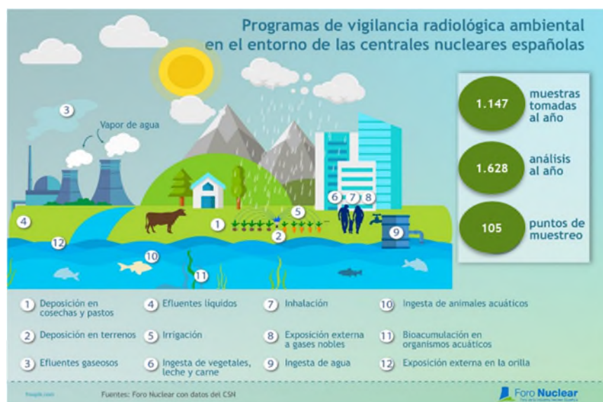
Figura 10. Esquema PVRA. Fuente Foro Nuclear. Datos C.N.Cofrentes 2019.
