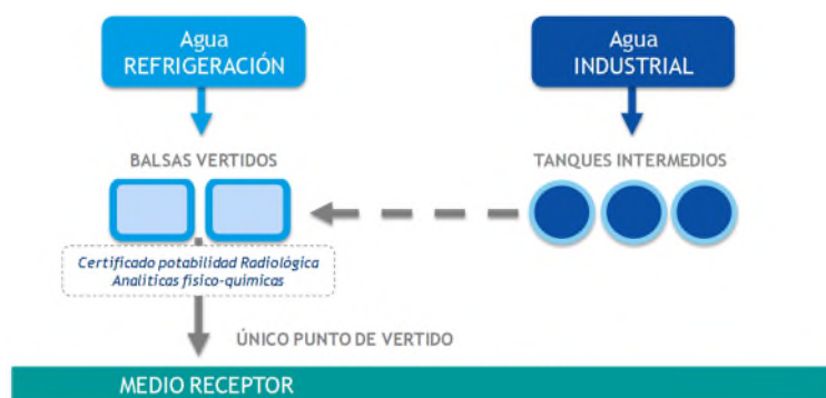
Figura 9. Esquema Sistema de Vertidos C.N. Cofrentes.
