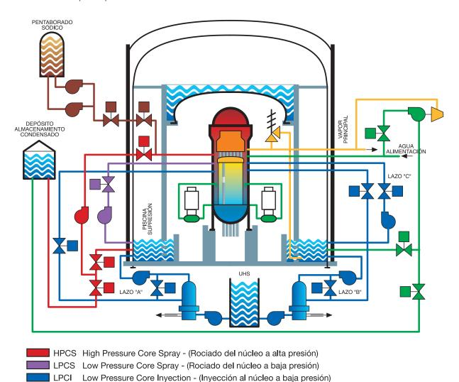
RCIC Reactor Core Isolation Cooling - (Refrigeración del núcleo aislado)
