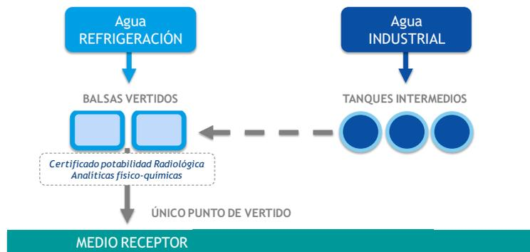
Figura 10. Esquema Sistema de Vertidos C.N. Cofrentes.
